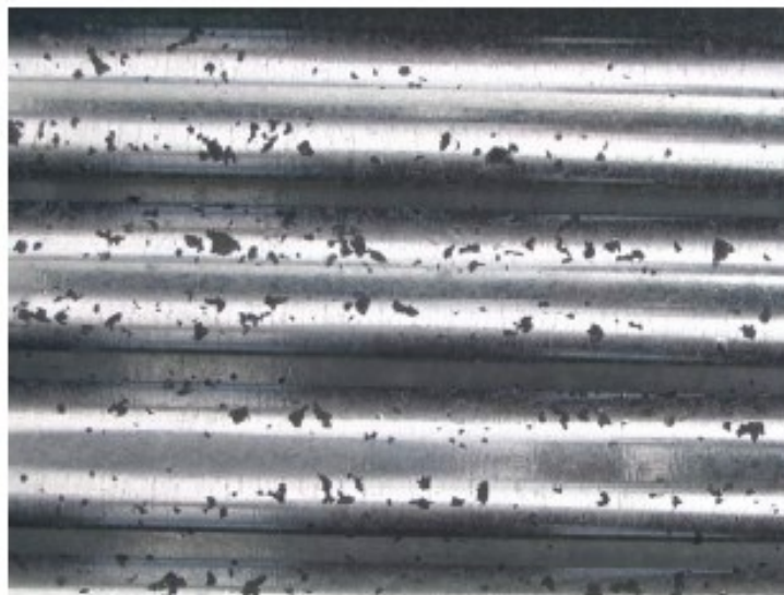
Figure 5 Abrasão durante o Transporte (atrito) em chapa de aço galvanizada ondulada
