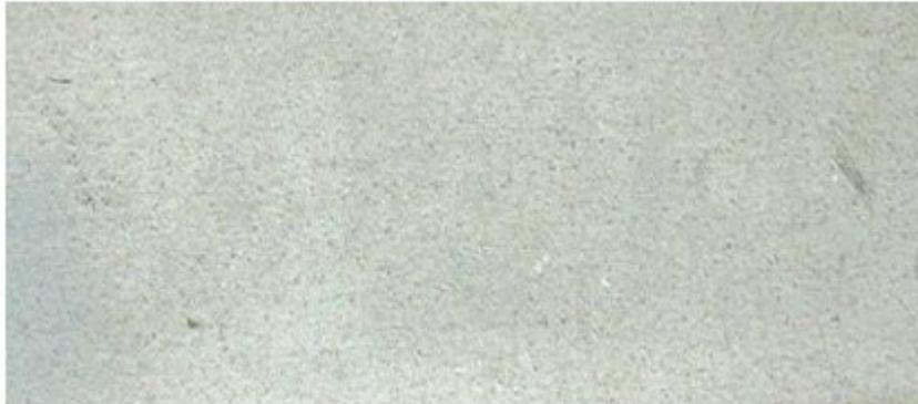
**Figura 1: Aparência normal de chapa de aço *galvannealed***
