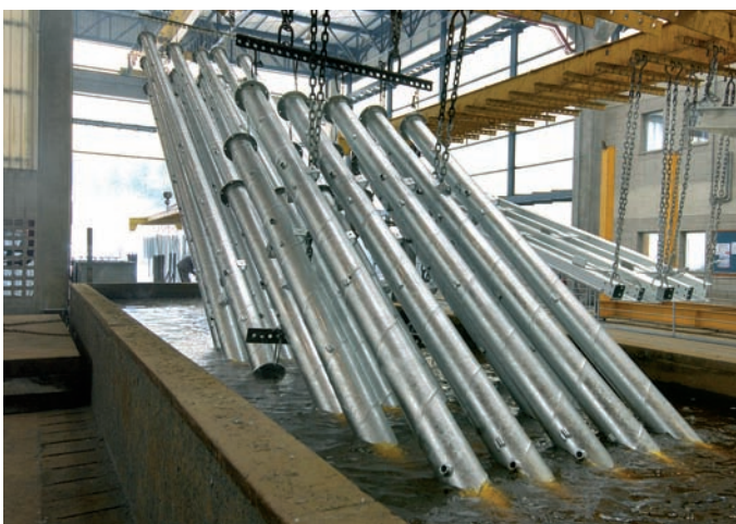
A galvanização é um processo em que o aço é revestido de zinco para preservar as qualidades de proteção contra a corrosão
