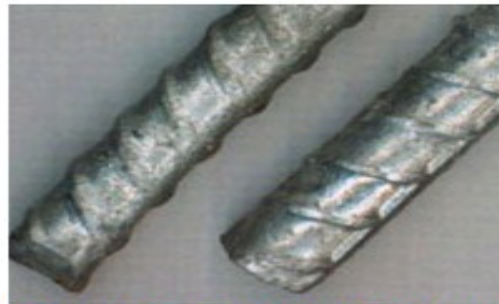
Aspecto de vergalhão galvanizado por imersão a quente Fonte: www.galvanizeit.com
